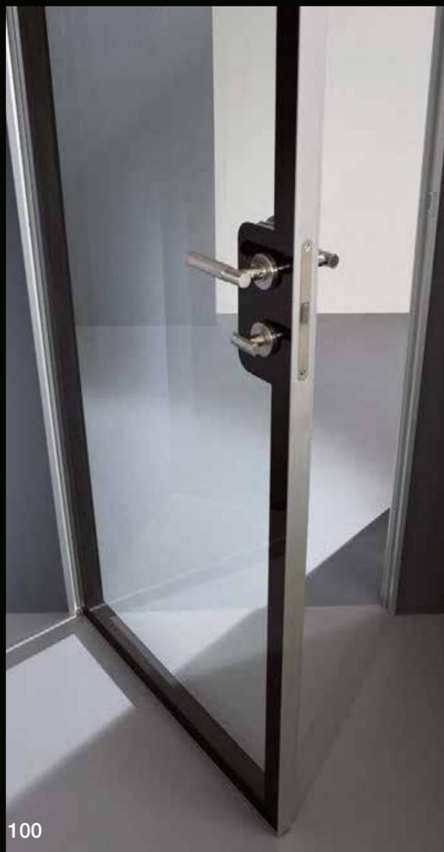
La nuova porta Planus Cinque Glass è progettata e prodotta utilizzando la tecnologia dei serramenti per esterni. Nel telaio in Alluminio è inserita una vetrocamera con sigillatura siliconica. All'interno è contenuto dell' Argon in modo da evitare la formazione di condensa e la sigillatura per evitare l'intrusione di corpi estranei.
